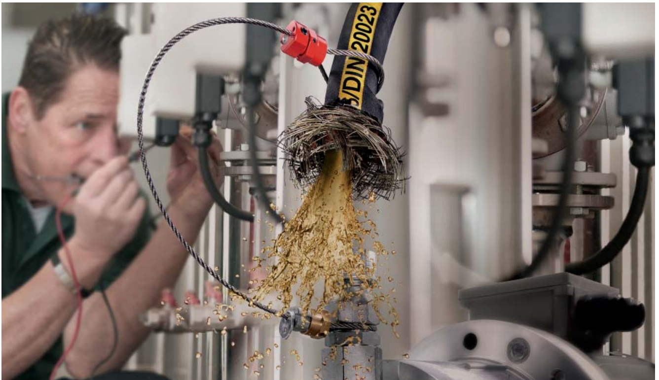
Cablelock®-Berstsimulation eines reißen den Hydraulikschlauches.
